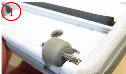
①糸くずや髪の毛を取り除き、シャフトにローラーを通し、ノズル本体の溝にシャフトをセットします。
