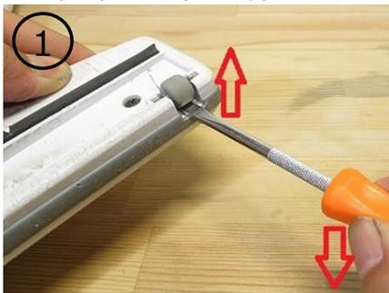
①ローラーの隙間にマイナスドライバーを差込み、テコの原理で持ち上げ外します。
