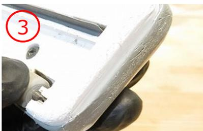
③正しい位置にシャフトをセットしローラーを指で押し込みます。パチンと音がすれば上手くシャフトが取り付けられたサインです。
