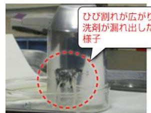
②約6時間後アルミ缶に亀裂が生じ、洗剤が漏れ出す。
